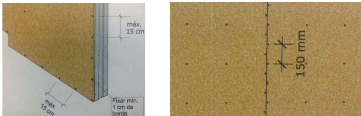
Figura 1 - Detalle del espaciado entre los tornillos que fijan las placas OSB.
